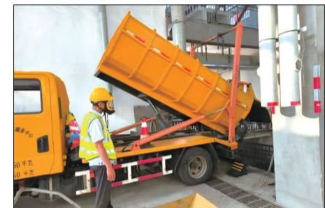
本报讯(YMG全媒体记者 杨春娜 通讯员 王家亮 摄影报道)昨天上午，套子湾污水处理厂的通沟污泥处理站内，一车污泥运抵这里，经过处理之后，变身建筑材料、泥沙等，得到进一步利用。排水管网和地下河道清淤的时候，会打捞上来大量沉积物，这便是通沟污泥。市区首座通沟污泥处理站投入使用，污泥在这里经过处理，实现无害化、资源化利用。
