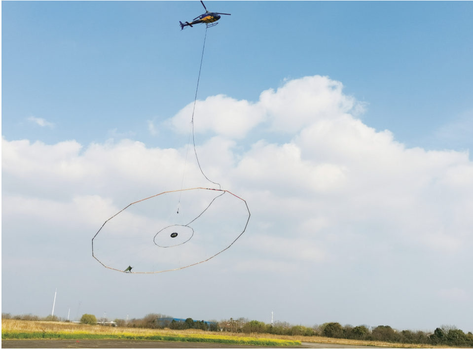
吉林大学深部探测与成像全国重点实验室常务副主任王言章教授团队针对千米地下复杂地质探测难题，团队搭建航空混场源电磁与SERF超高精度磁测多元探测体系。自研直升机电磁装备如同“地球CT扫描仪”，穿透地层还原地下岩层结构；SERF磁力仪可分辨地球磁场十亿分之一的微弱变化，两套技术互为印证，让地下岩层、矿产、地质隐患可测可视。新华社
