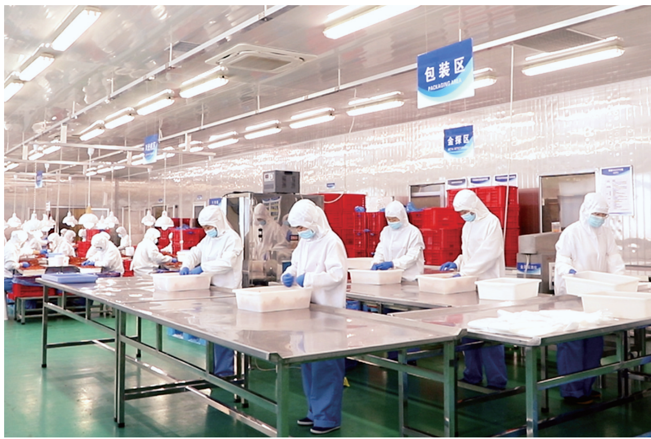
在烟台盛隆食品有限公司深加工生产车间，工人们有条不紊地完成苹果清洗、去皮、去核等工序。
