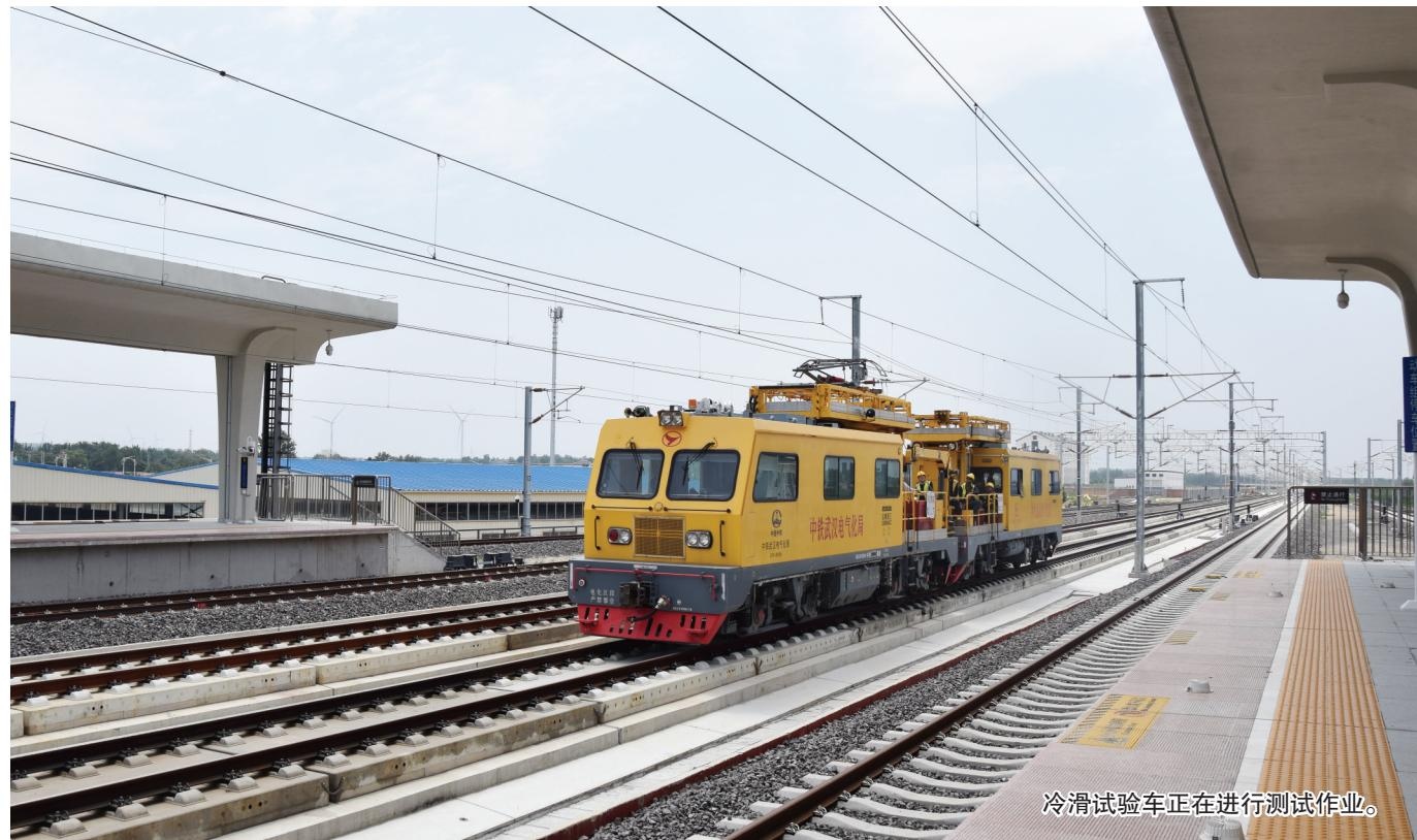
冷滑试验车正在进行测试作业。
