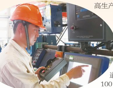
高生产效率2倍。他参与完成我国自主研发的华龙一号全球首堆——中核福清核电5号机组和华龙一号海外首堆——巴基斯坦卡拉奇2号机组主管道焊接工作。华龙一号材料结构复杂,他通过改制现场焊工装及焊接顺序,顺利完成主管道焊接工作,焊缝一次交检合格率100%,焊接变形全部控制在工艺范围±0.3mm内,水压试验100%合格。
