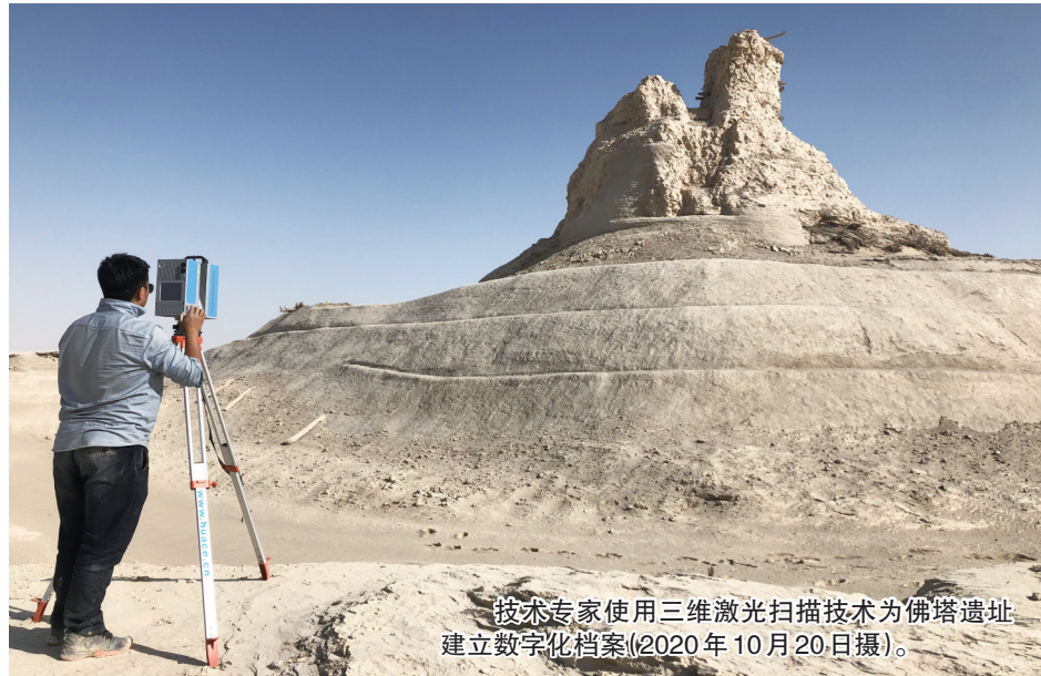
技术专家使用三维激光扫描技术为佛塔遗址建立数字化档案(2020年10月20日摄)。
