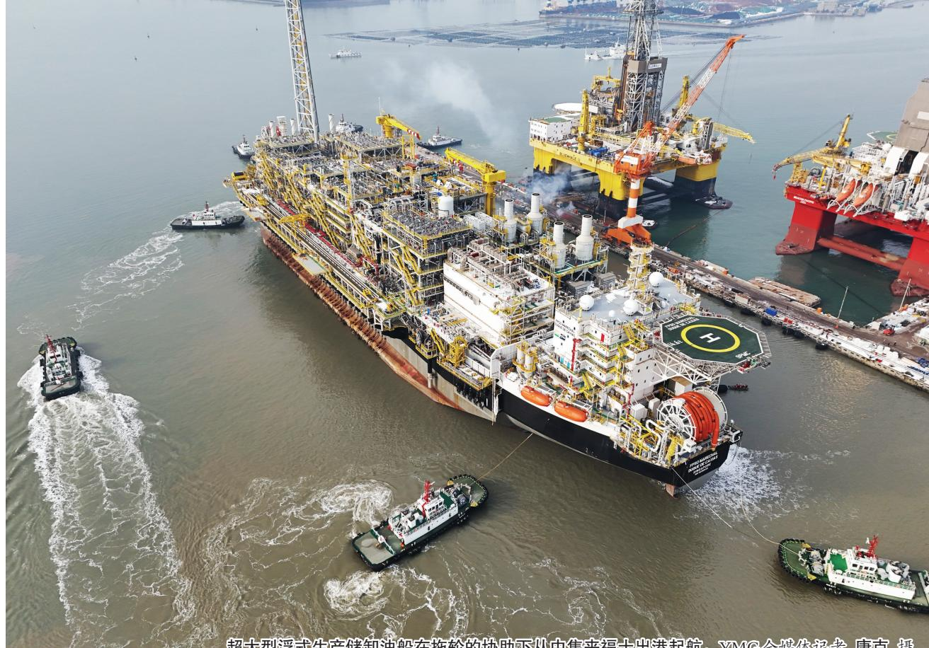
超大型浮式生产储卸油船在拖轮的协助下从中集来福士出港起航。YMG全媒体记者 唐克 摄
