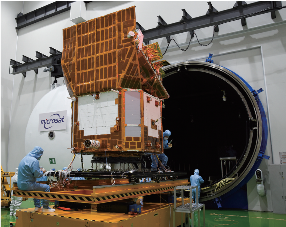
2023年7月20日，在中国科学院微小卫星创新研究院，科研人员在做爱因斯坦探针卫星的热试验。2024年1月9日15时03分，我国在西昌卫星发射中心使用长征二号丙运载火箭，成功将爱因斯坦探针卫星发射升空，卫星顺利进入预定轨道，发射任务获得圆满成功
