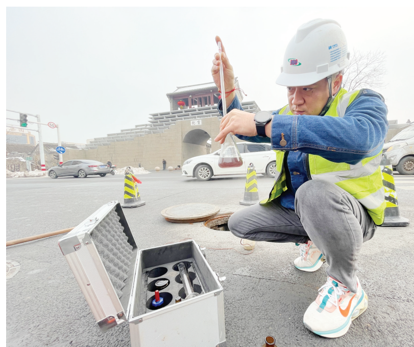
牟晓峰正在检测管网水质判断是否有漏点。
