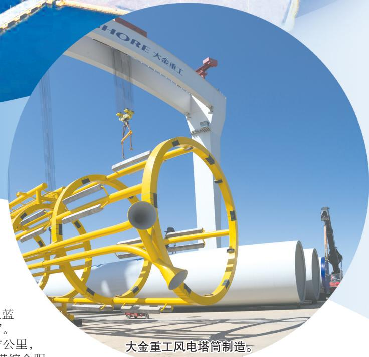
大金重工风电塔筒制造。
