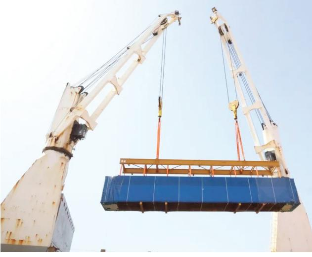
近日,随着自重213T的大件模块在两台船机配合操作下稳稳落入“长江”轮船舱内,山东港口烟台港蓬莱港公司首次实现双船机自主抬吊作业获得成功,并创造模块最快吊装时间20分钟的新纪录。
