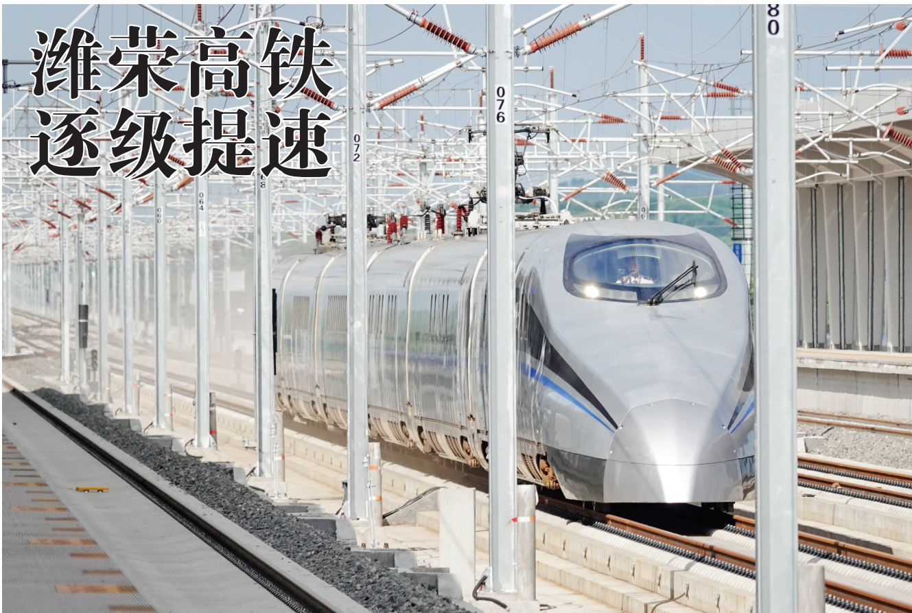
昨日，一列高速综合检测列车通过潍荣高铁莱荣段海阳站。7月15日起，潍荣高铁莱荣段开始进行高速综合检测列车逐级提速试验，为开通运营做好准备。
