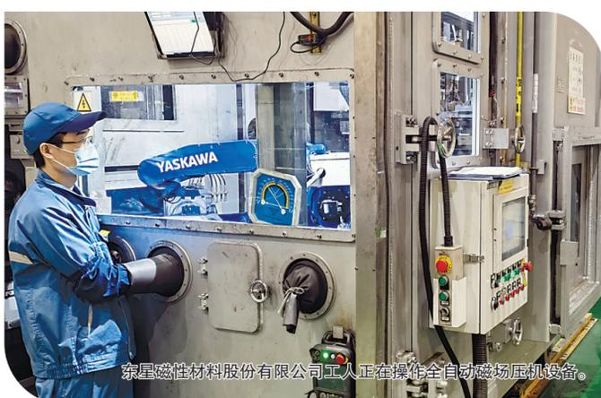
东星磁性材料股份有限公司工人正在操作全自动磁场压机设备。
