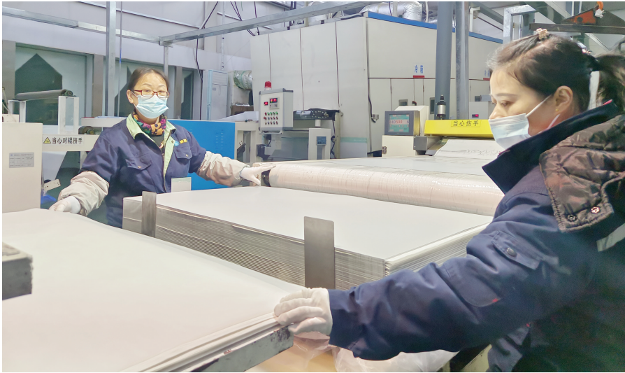
柳鑫新材料生产车间内,工人们正在MVC涂胶生产线上进行电子盖板涂覆检查、裁剪、包装等工作。
