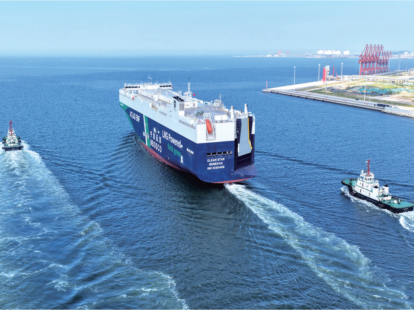
近日,由中集来福士公司为希腊建造的7000车位双燃料汽车运输船“洁净之星”轮在山东港口烟台港龙口港区投入运营。该船配备液化天然气(LNG)动力系统,同时采用“氨预留”设计,后期可升级为氨燃料动力系统,并满足国际海事组织最新的新能源汽车海运安全标准,获得挪威船级社“氨预留”和“电动汽车装载”双认证。
