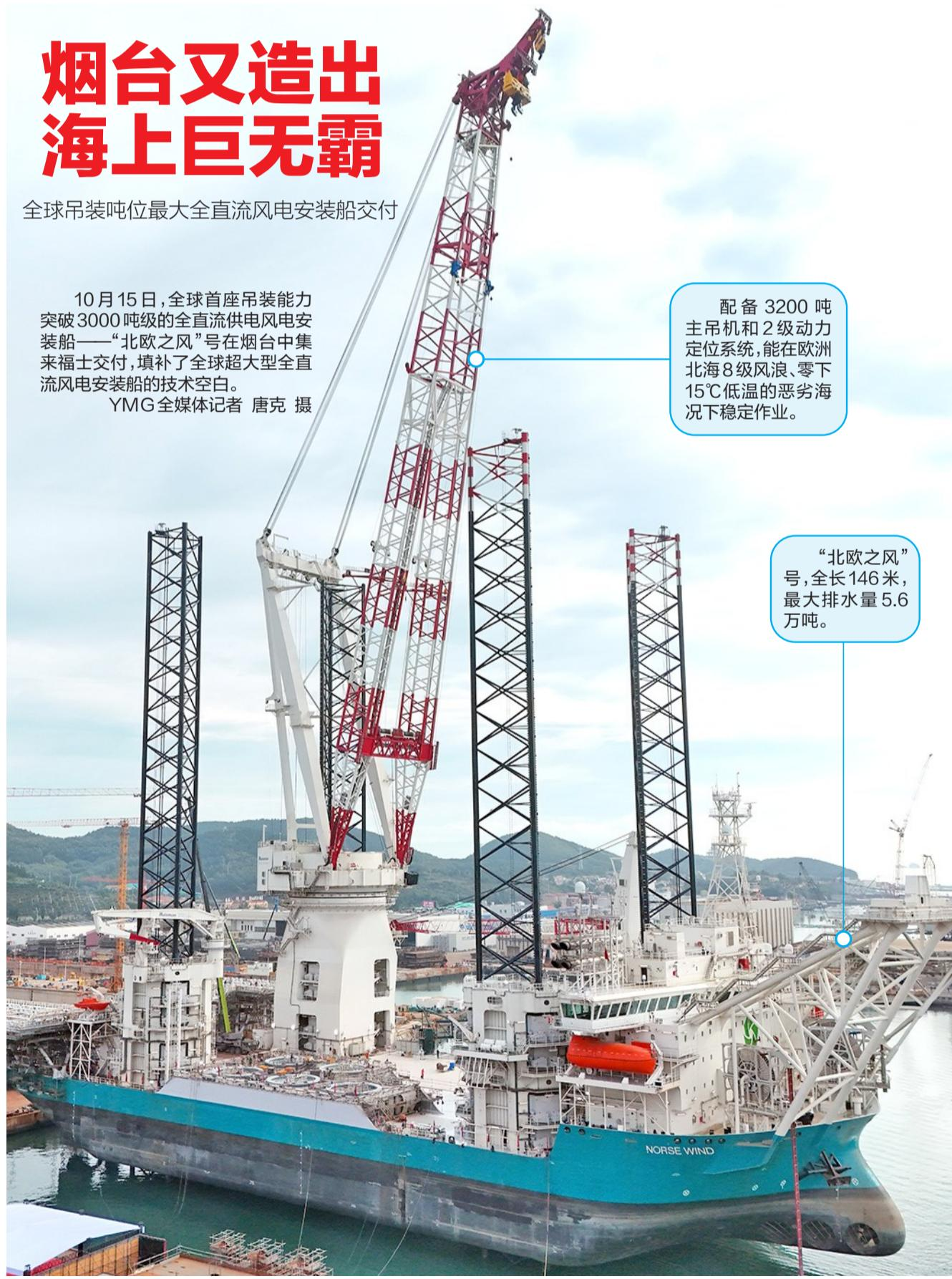
配备3200吨主吊机和2级动力定位系统,能在欧洲北海8级风浪、零下15℃低温的恶劣海况下稳定作业。
