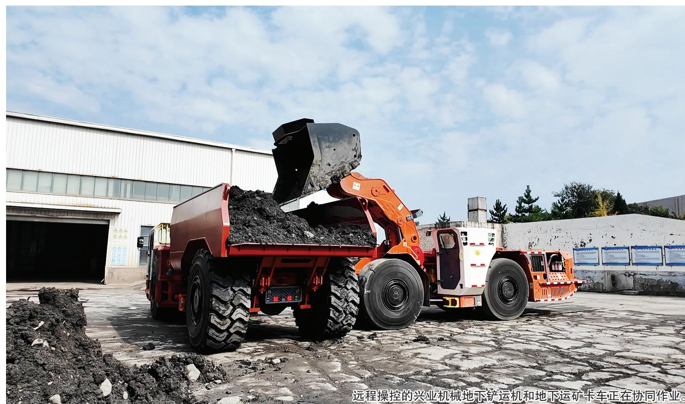
远程操控的兴业机械地下铲运机和地下运矿卡车正在协同作业。
