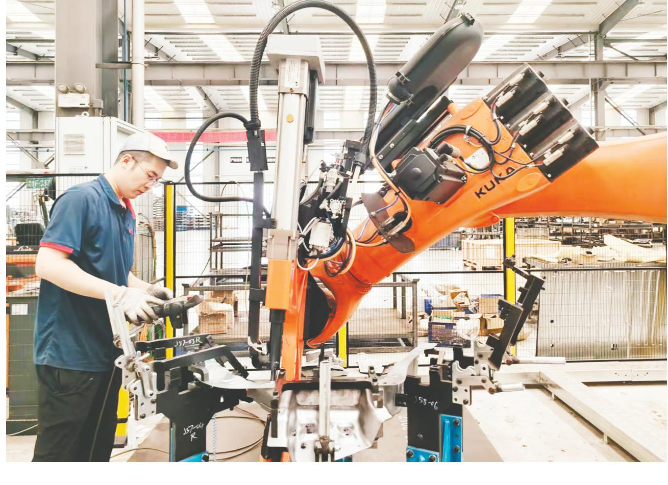
“一部铝制的白车身有600—700个零件。铝制零件不仅强度要够,它的硬度、回弹、精度、质量等指标,全部达到钢零件的标准,目前国内还没有全铝合金零件开发。我们企业率先进行对铝车身大型覆盖件、关键件进行开发。”据介绍,企业钢铝白车身研发和生产领域处于国内领先地位。
