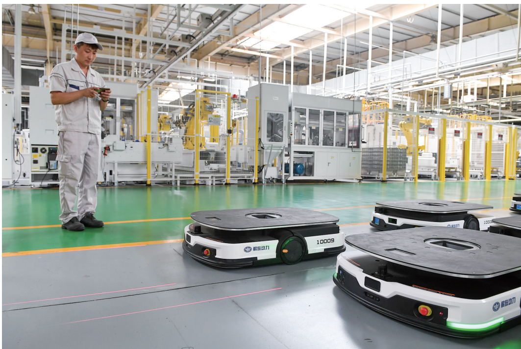
在一汽解放动力总成事业部长春工厂集成AMT车间,工人对AGV搬运机器人进行动作测试(2024年8月5日摄)。 新华社
